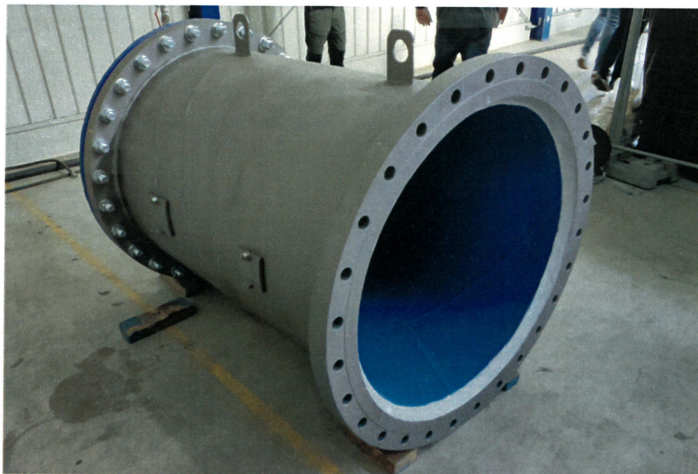
Zdjęcie 1. Element próbny – rura \text{Ø}1000 mm z widoczną powłoką wewnętrzną i dwoma zakrytymi otworami kontrolnymi przed badaniami.
