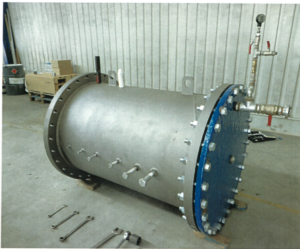
Zdjęcie 2. Element próbny – rura \varnothing 1000 mm z widocznymi zamkniętymi nagwintowanymi otworami kontrolnymi przed badaniami.
